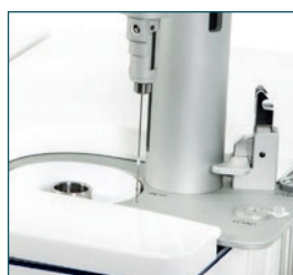
Unique pipette and titration syringe .
